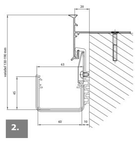
Das Randprofil wird mit 2-5 mm Abstand untereinander bzw. zur Randprofileecke an den Balkon angebracht und der Verbinder wird mit dem MortaColl® FIX MS verklebt.
